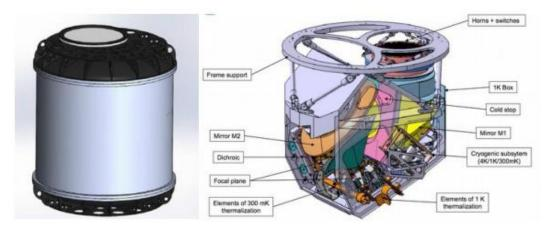
Fig. 2 Vista de la parte externa del crióstato (izquierda) y de los componentes principales del sistema completo (derecha).
